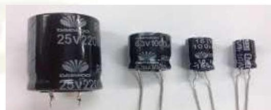
Gambar 2. 22 Kapasitor Elektrolit
