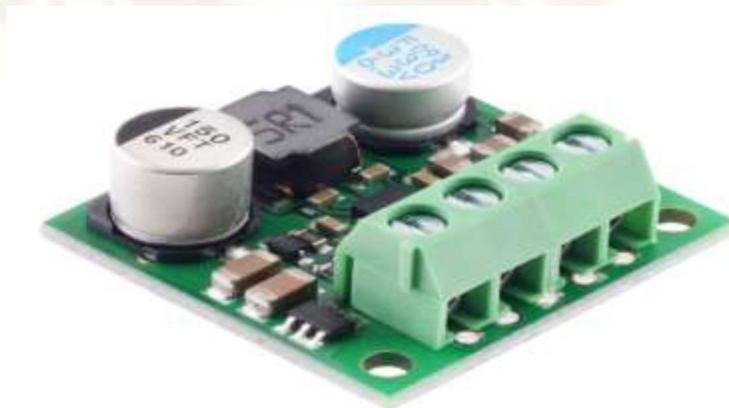
Gambar 2. 15 Step Down 5V
