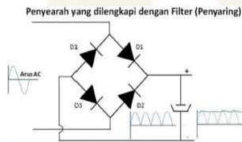
Gambar 2. 25 Dioda Penyearah Gelombang Yang Dilengkapi Kapasitor
