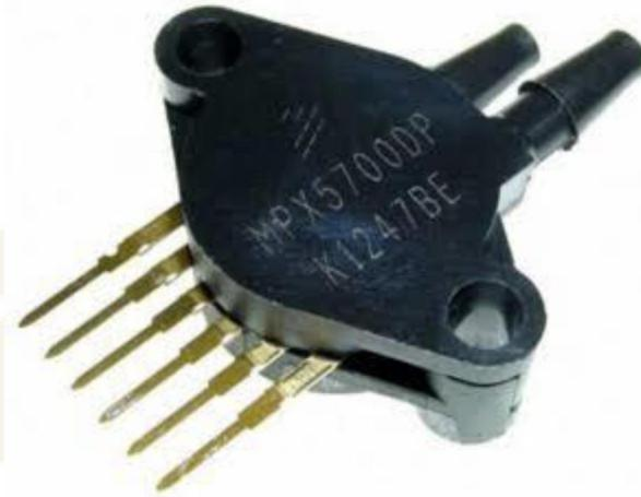
Gambar 22. Sensor Tekanan Udara MPX5700DP
