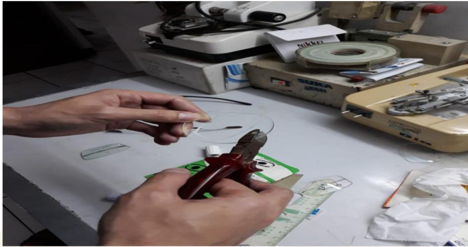
Gambar 4.2 Pada saat memotong Lensa
