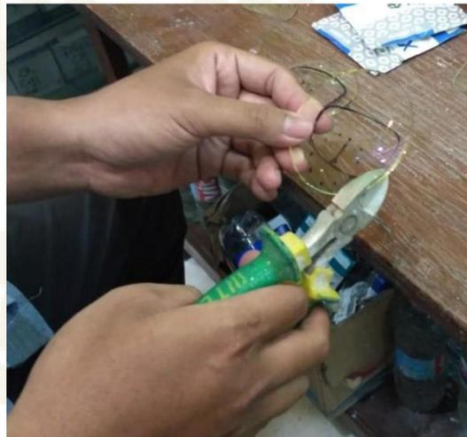
Gambar 4. 3 Pemotongan Tepi Lensa
