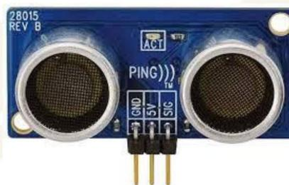
Gambar 22. Sensor Ultrasonik
