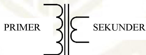
Gambar 15 Trafo Step Down
