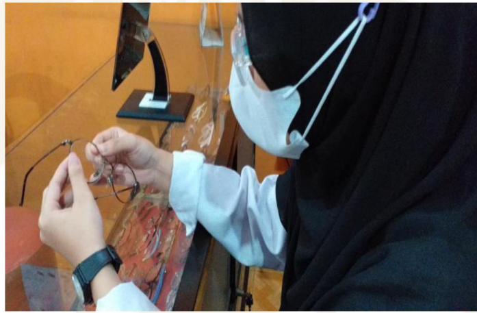
Gambar 4. 7 Pemasangan Lensa Pada Frame
