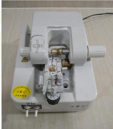
Gambar 2. 24 Mesin Groover
