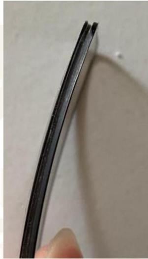
Gambar 2. 18 Bevel tersembunyi
