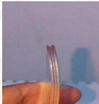
**Gambar 2.18 Bevel tersembunyi**
