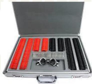
*Gambar 2. 7 Trial frame dan trial lens*
