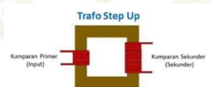
Gambar 2. 15 Trafo Step Up
