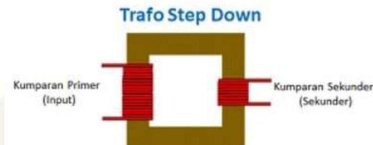
Gambar 2. 16 Trafo Step Down
