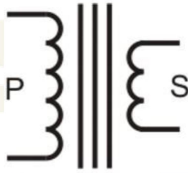
Gambar 5. Skema Trafo Step Down
