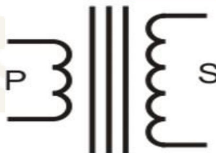
Gambar 4. Skema Trafo Step UP
