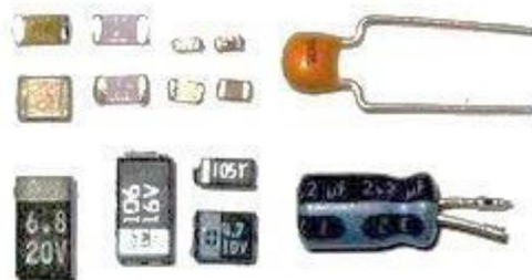
Gambar 6 Bentuk Fisik Kapasitor
