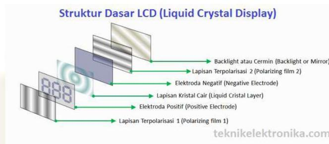
Gambar 2. 25 Struktur LCD
