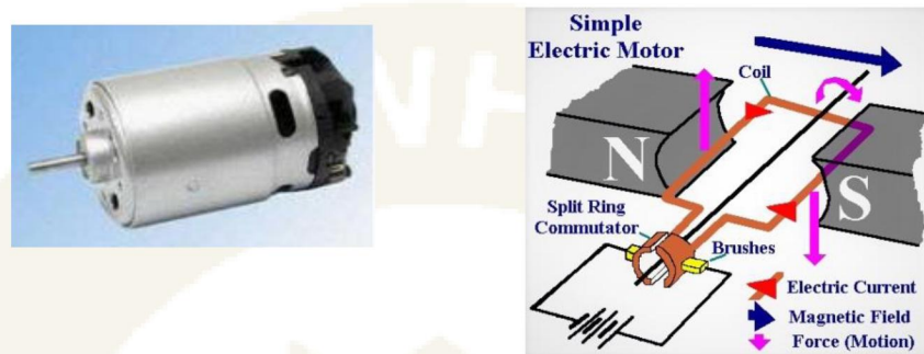
Gambar 18. Motor DC & Sistem Kerjanya
