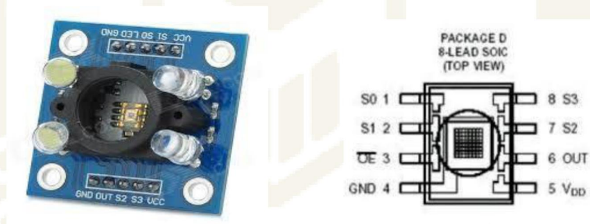
Gambar 21 Bentuk Fisik dan Skema Pin TCS 3200
